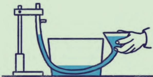
Pour répondre à cette question posée par Marie Curie, on utilise un matériel simple : un récipient, un tuyau avec un entonnoir fixé à une extrémité et une sortie aménagée de l'autre côté du tuyau, un support pour tenir l'ensemble. Il s'agira pour les élèves de faire communiquer un réservoir, par un tuyau, à un tube muni sur le côté d'une sortie d'eau (voir illustration ci-dessus) et observer ce qui se passe en fonction de la hauteur à laquelle on positionne le réservoir<sup>3</sup>.
